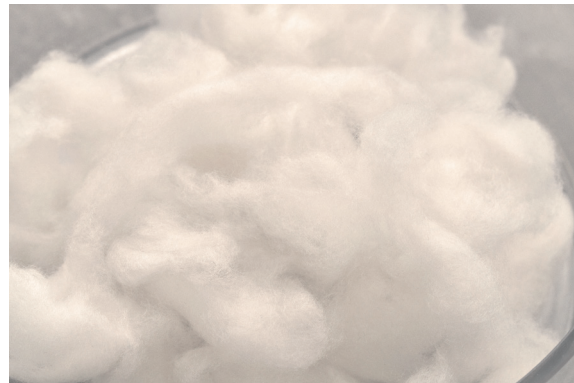
Figure1-3 : Brewed Proteinフィラメントを短くカットし、開毛した短繊維。繊維同士の絡み合いの具合や、綿の空隙率によってその後の素材の風合いが大きく変化する。
