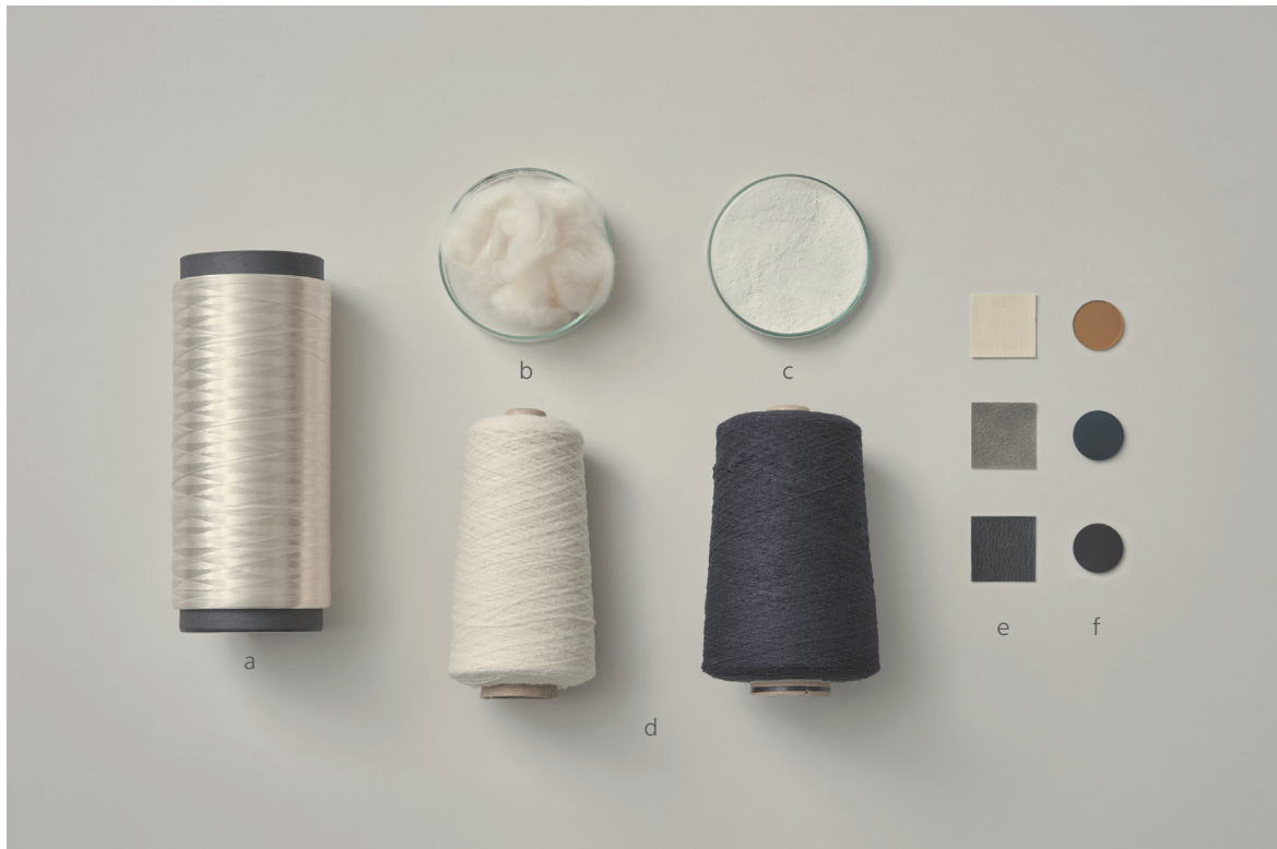
Figure1-1 : Brewed Protein™素材。(a) 長繊維、(b) 短繊維、(c) ポリマー、(d) 紡績糸、(e) レザー、(f) レジン
